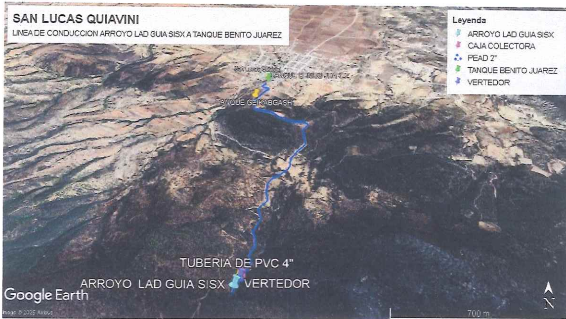
FIGURA 4.- LÍNEA DE CONDUCCIÓN DEL ARROYO LAD GUIA SISX AL TANQUE GEIKABGASH DE AHÍ HASTA EL TANQUE BENITO JUÁREZ.
