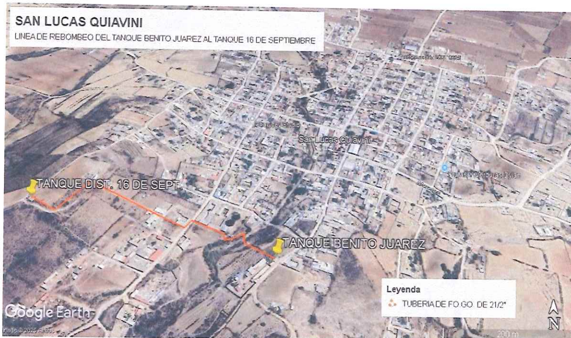
FIGURA 7.- LÍNEA DE REBOMBEO DEL TANQUE BENITO JUÁREZ. AL TANQUE 16 DE SEPTIEMBRE.
